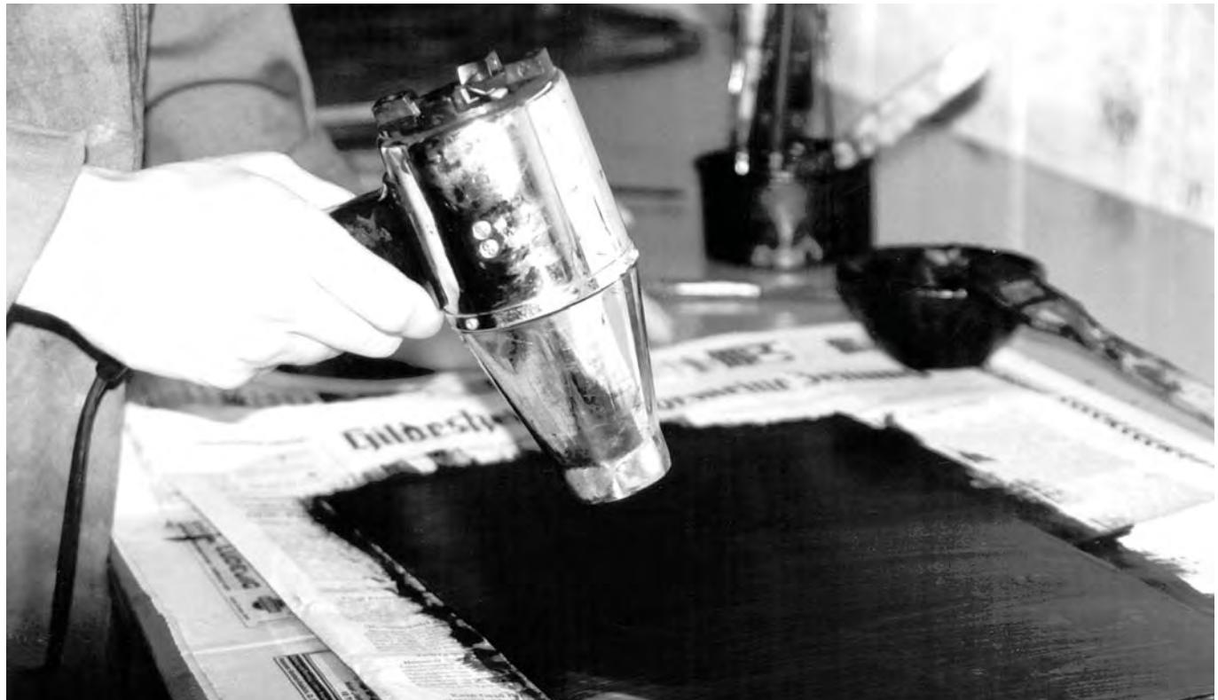
9. Για να επιταχυνθεί η διαδικασία του στεγνώματος του βερνικιού, χρησιμοποιείται ένας πλεκτρικός στεγνωτήρας.
